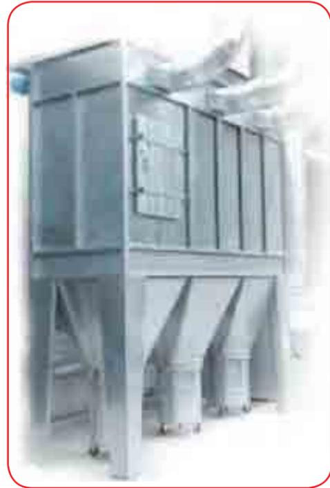
Filtro modulare a cartucce (BIA/U.S.G.) per la depurazione di fumi e polveri derivanti da processi di saldatura o taglio. Studiato per impianti centralizzati anche di portata elevata dispone di sistema di pulizia automatica ad aria compressa per mezzo di programmatore ciclico con depressostato differenziale. Portata max 31.000 m<sup>3</sup>/h.
