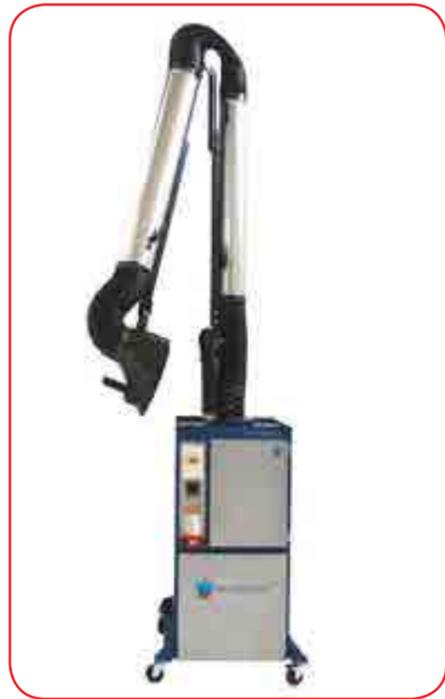
Unità carrellata da 1,5 HP per l'aspirazione e la filtrazione di fumi di saldatura in impieghi poco gravosi. Agile, maneggevole e performante, ECOMINOR è equipaggiato con una batteria di 4 filtri in sequenza per filtrare meccanicamente e deodorare il fumo aspirato. Braccio autoportante articolato da 3 mt incluso. Portata max di 1.400 m<sup>3</sup>/h. Idoneo per impieghi poco gravosi.
